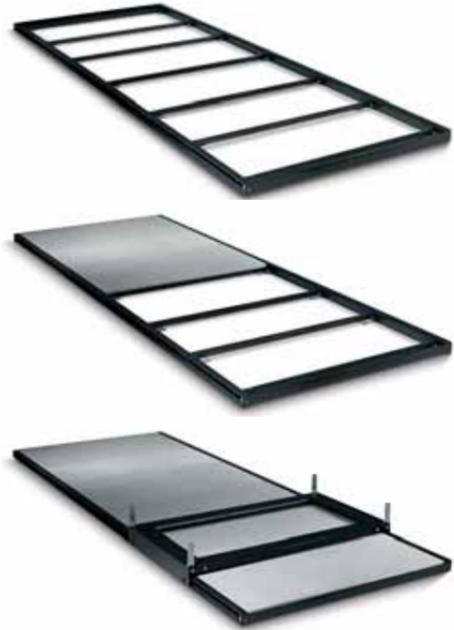
Solide Basis ist ein nur 50 mm hoher Stahl-Podestrahmen mit Laufschiene, der „vor Ort“ verschraubt und auf den Boden gelegt wird. Integrierte Höhenausgleichsschrauben gewährleisten eine absolut waagerechte Platzierung und gleichmäßige Lastverteilung über Druckplatten. Die Podestplatten mit widerstandsfähiger, tritt- und rutschfester Kunststoff-Oberfläche (antislip granit, grauweiß gesprenkelt) gibt es optional auch mit Parkett oder anderen Belägen.
