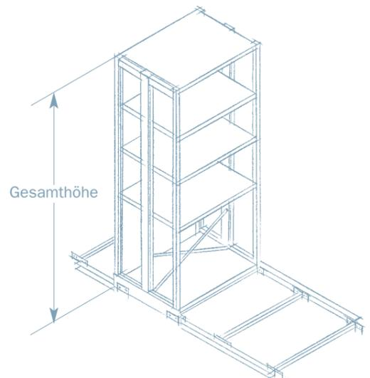
Bis zu 10 Rollregale lassen sich „am Stück“ gleichzeitig leicht verfahren. Für die Stellfläche ist dabei noch der Raum für 1 Zwischengang (mind. 750 mm) zu berücksichtigen. Additive Erweiterungen sind nach diesem Prinzip uneingeschränkt möglich.
